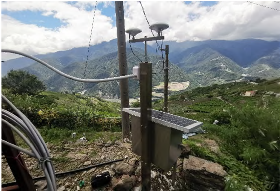
圖 3-11 雙頻 GPS 觀測站 ( 含雨量計伸縮計及傾度盤 )
