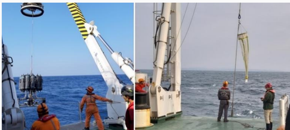
圖 9-6 CTD 採水（左）及動浮網採樣作業（右）
