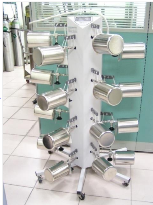
16個採樣罐自動分析儀
