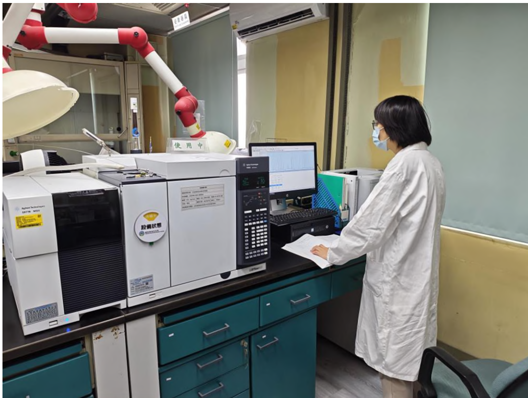
國環院人員操作氣相層析質譜儀器
