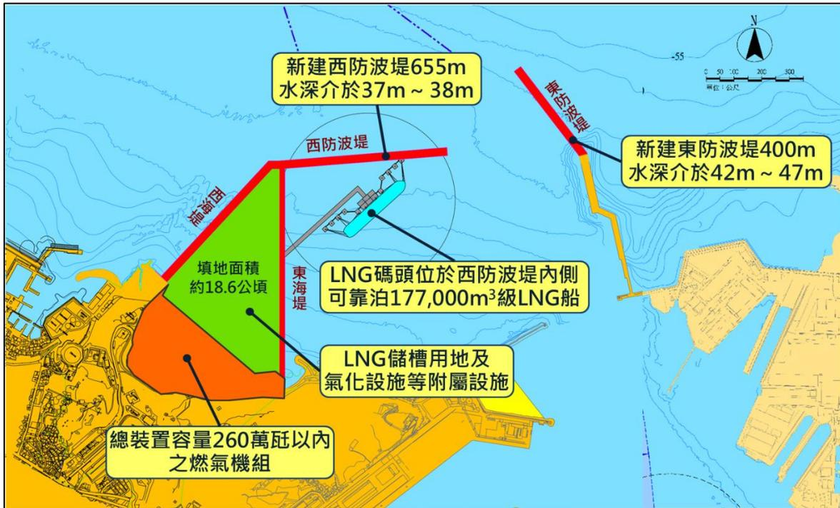
圖 4.2-3 原(替代)方案填海造地工程範圍示意圖
