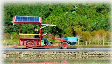
電動鐵牛車頂棚裝有太陽能板， 微水力綠電作為載具之電能來源
