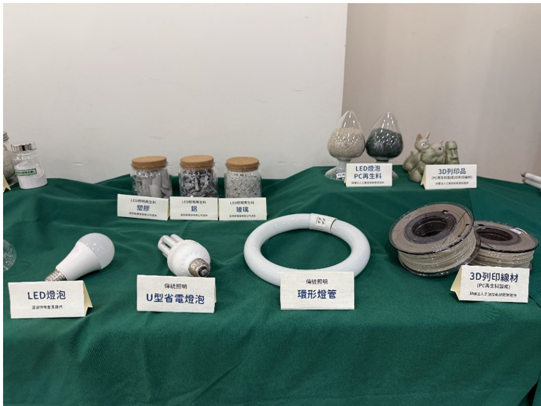
展示品 再生品 照明光源回收後，其中塑膠可再製成 LED 路燈外殼與 3D 列印線材原料等
