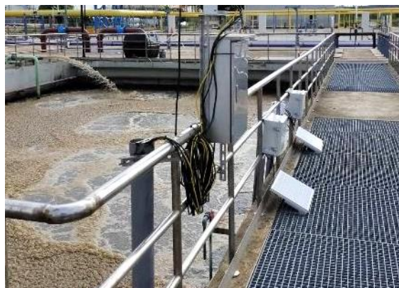
圖 7 好氧池測試電極自清功能之布建照
