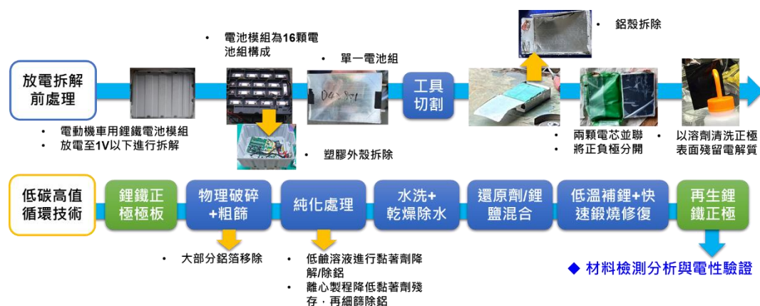
圖 3、汰役車用鋰鐵電池低碳高值循環製程程序開發
