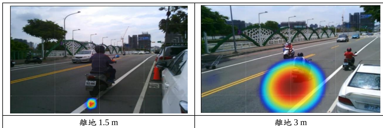
圖1 不同架設高度陣列式麥克風偵測範圍示意圖
