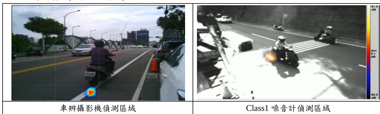
圖2 不同方向陣列式麥克風偵測範圍示意圖
