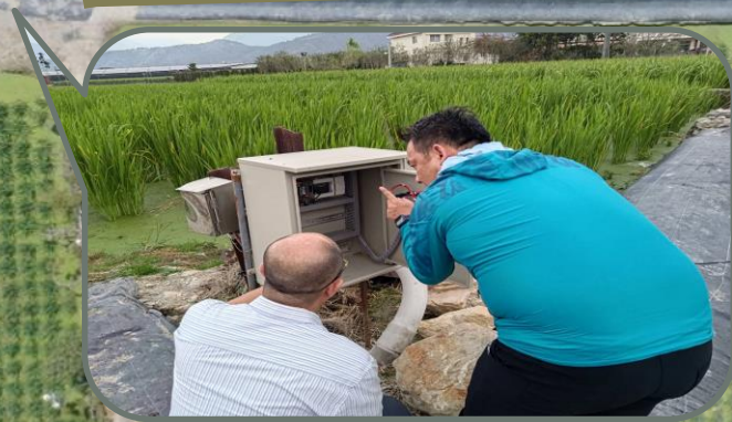
馬達抽水控制、田中(進/出水口)溫度感測數據收集
