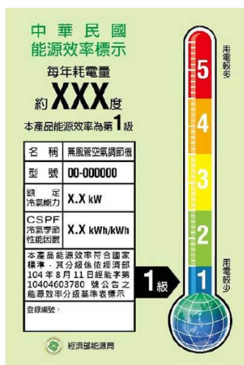
圖 j 採用一級能效分離空調機組(EAC=0.61) 附圖
