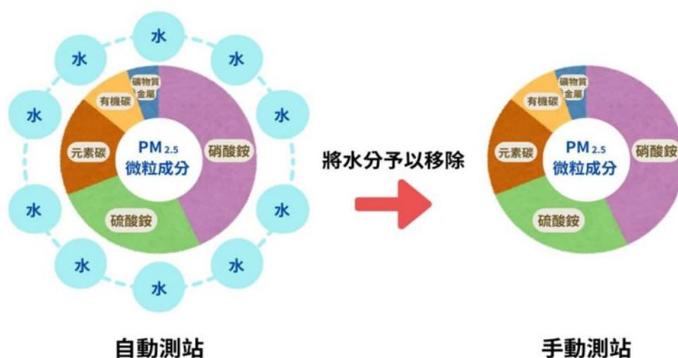
圖 1、 $PM_{2.5}$  手動量測去除水分干擾示意圖
