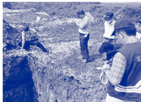
配合環保稽查人員開挖丈量非法回填廢棄物場址
