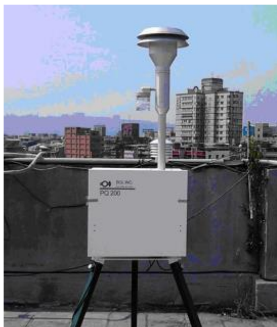
圖 3.1.4 BGI PQ200 氣膠採樣器
