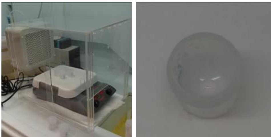
圖 3.4.6 無塵箱內微粒樣品溶液加熱蒸乾
