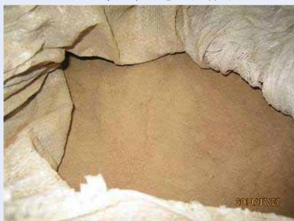
含金屬之印刷電路板廢料粉屑
