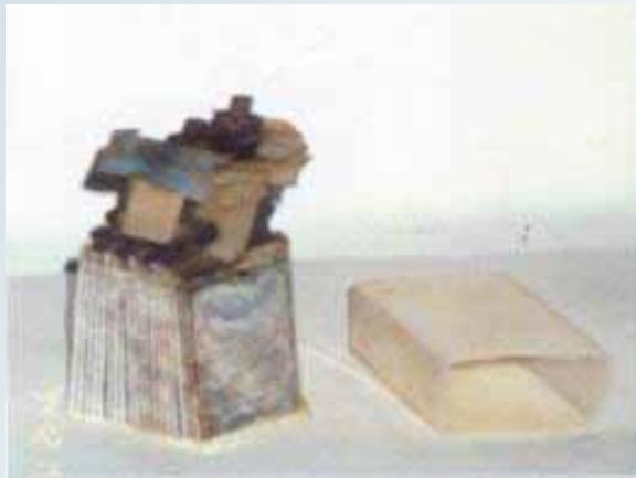
廢鎳鎘電池拆卸內部構造
