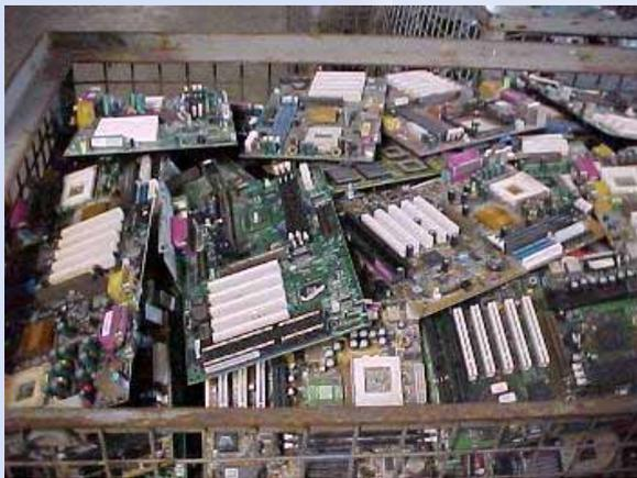
附零組件之廢印刷電路板
