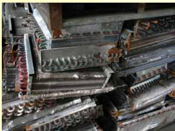
銅鋁混合廢料-家電散熱片
