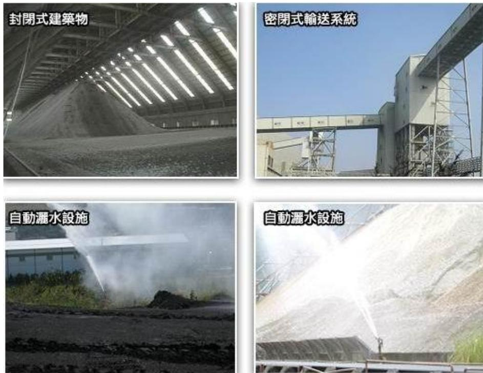
圖 5.2-11、逸散污染源可採行之防制設施
