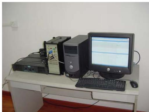
圖 5.2-36 隔音測量系統
