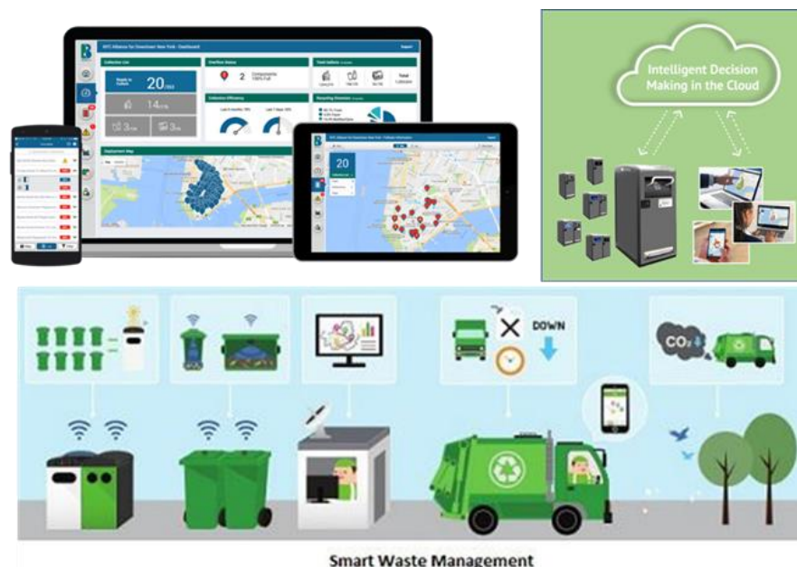
圖 7-17、利用 IoT 技術智能規劃垃圾車出動時機及路線
