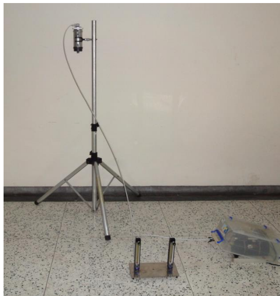
圖 3.2.16 R&P 3500 Speciation Sampler 的採樣配置，每種 PM 2.5 成分監測需配一個腳架、流量計、幫浦。
