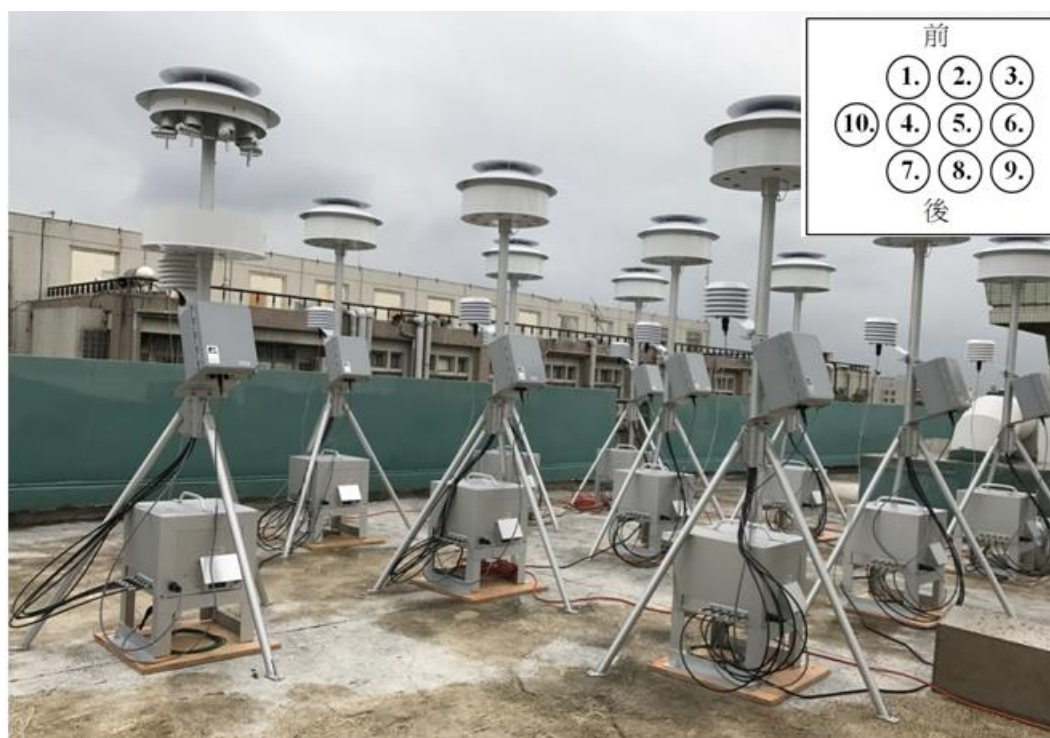
圖 4.1.1 十部 MetOne SASS 成分採樣器平行比對設置情形 (2016 年 12 月 19 日~12 月 22 日)
