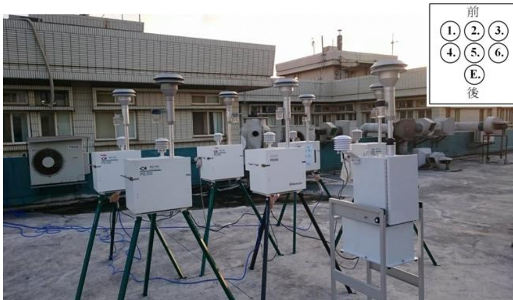
圖 4.1.2 六部 BGI PQ200 質量濃度採樣器平行比對設置情形 (2016 年 12 月 19 日~12 月 22 日)
