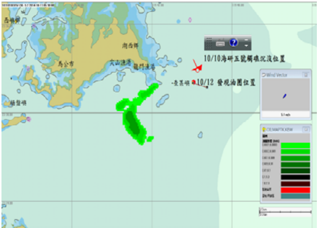
圖3: 103年10月12日進行海研五號研究船沉沒地點周邊海面油污污染擴散模擬作業
