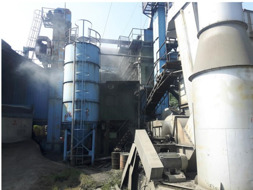
▲ 瀝青混凝土之裝卸、輸送、拌合作業，易致空氣污染
