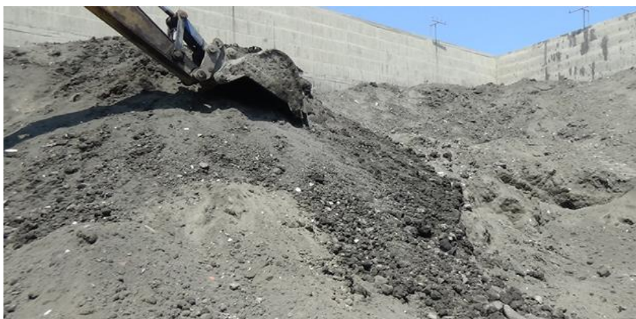
成品堆置區堆置物為粉狀夾雜大小不一顆粒樣態，顯未有造粒成形
