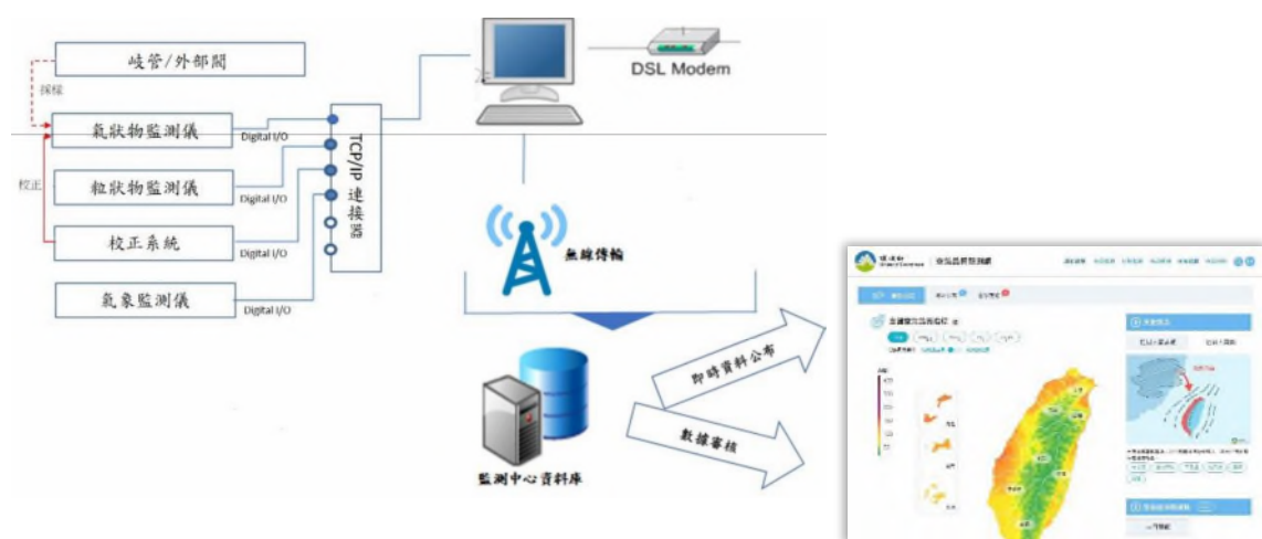
圖 2-1 空氣品質監測網資料傳輸流程圖
