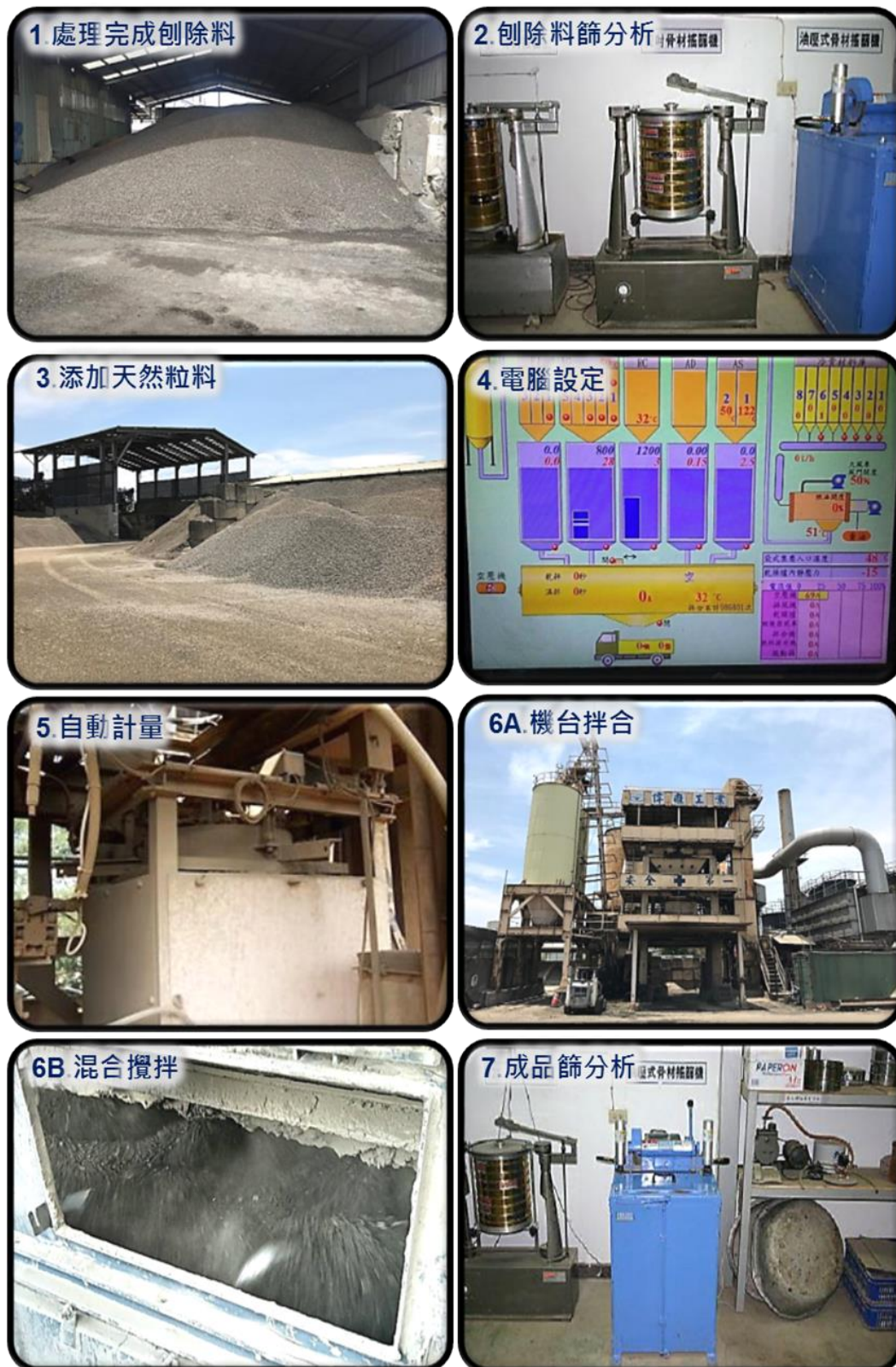
圖 2.5.2-4 瀝青刨除料再生處理流程及相關檢驗方式
