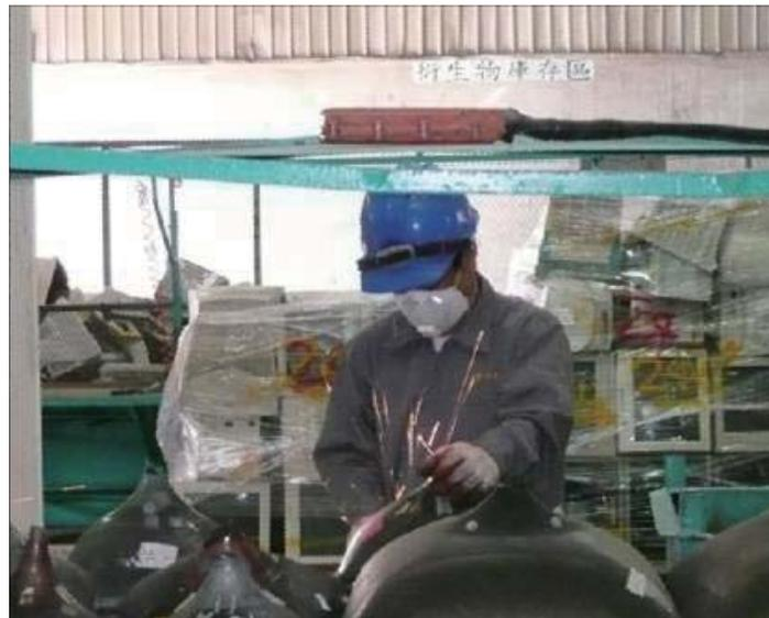
圖：工作人員正在處理已拆解之電視映像管
