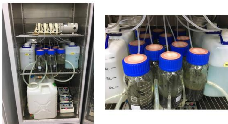
圖 3-6 模擬底泥接觸反應槽於恆溫箱之實際設置照片
