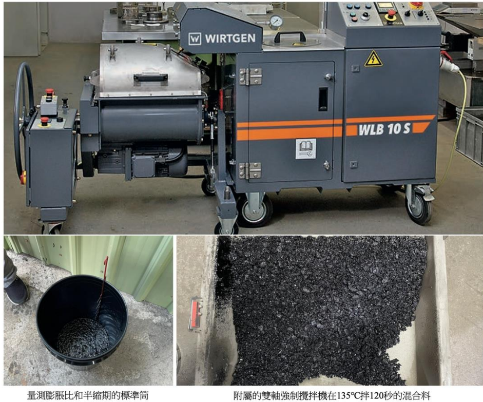
圖3. 實驗室橡膠瀝青發泡拌製溫拌瀝青混凝土的照片
