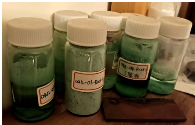
圖10濾液中的銅離子回收分離純化樣品圖
