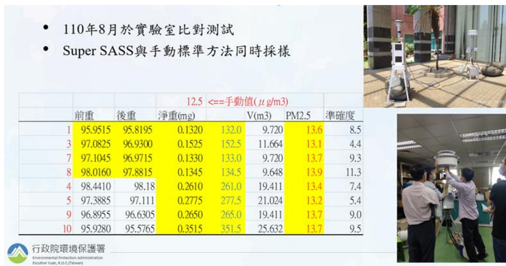
圖 1. 實驗室 Super SASS 與手動 PM 2.5 採樣器平行比對結果
