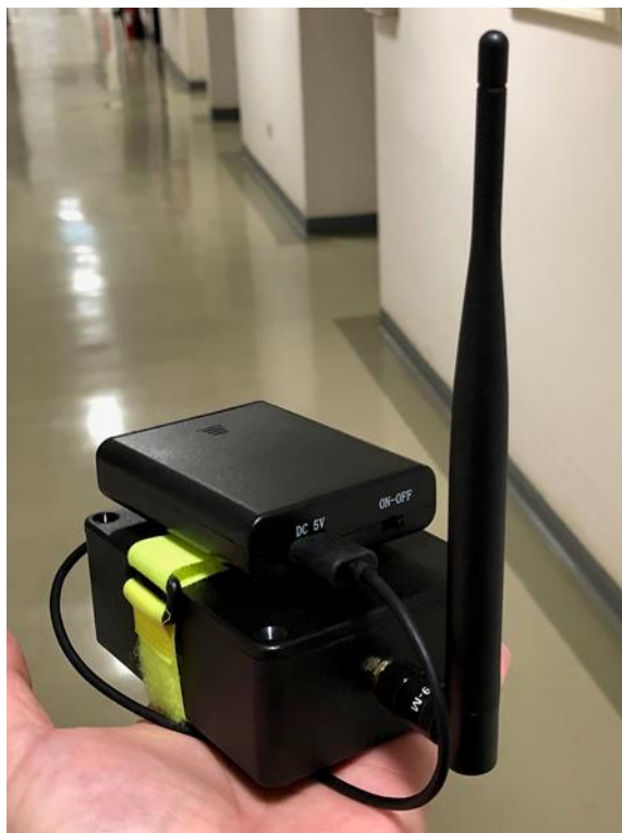
圖 3-15、LoRa 訊號測試用發射器
