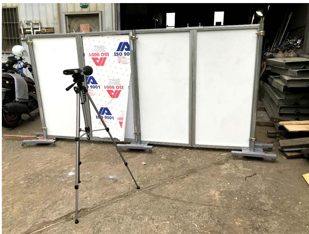
圖4.4-15 透明移動式防音隔屏背面
