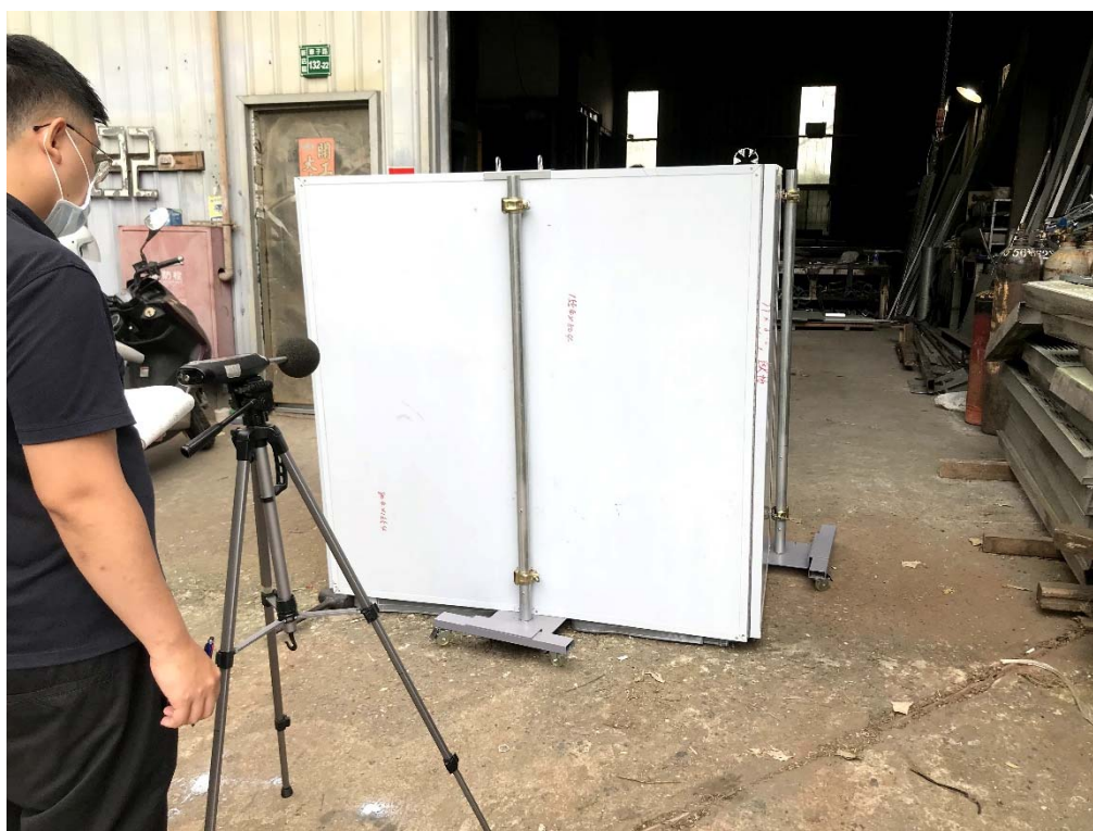
圖4.4-11 移動式防音隔屏90°背面
