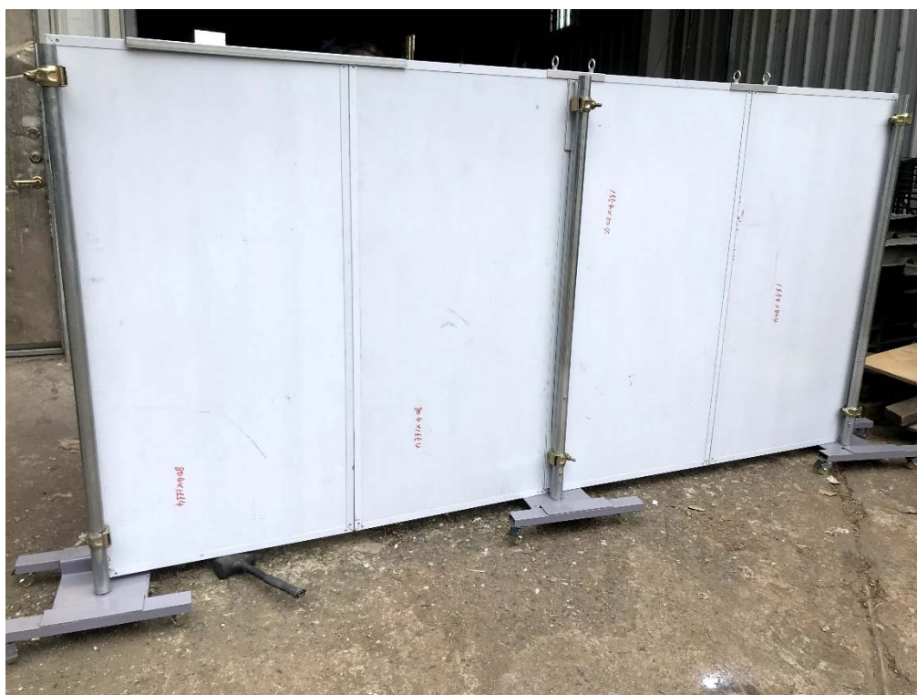
圖4.4-3 移動式防音隔屏成品背面
