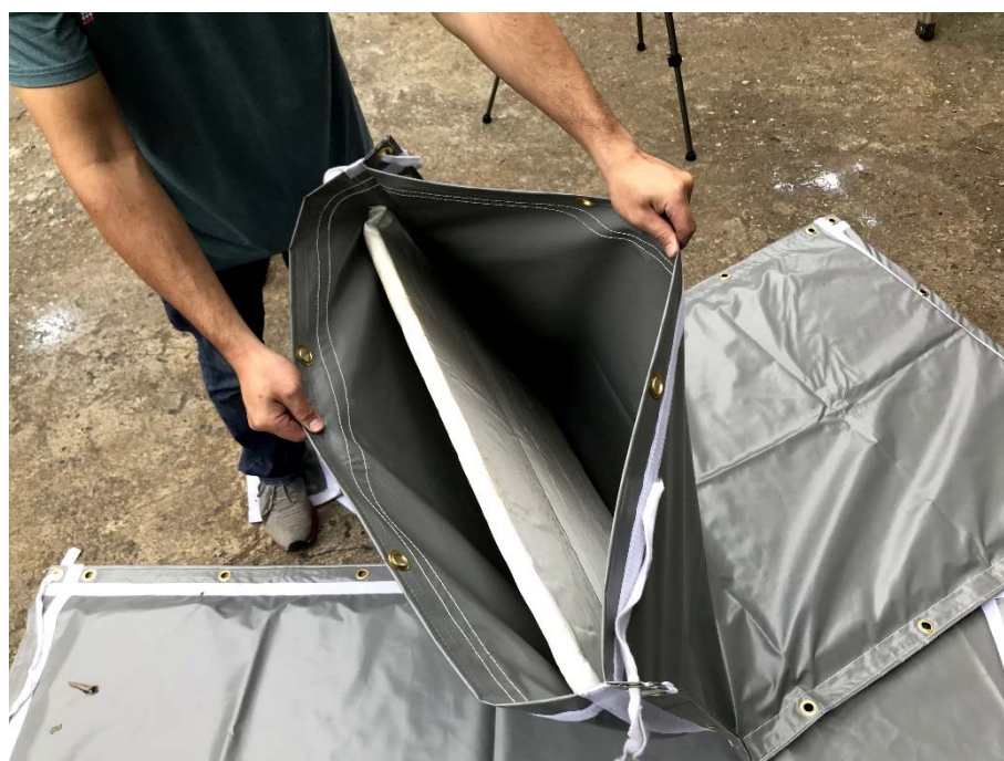
圖4.4-24 自製防音毯+吸音棉
