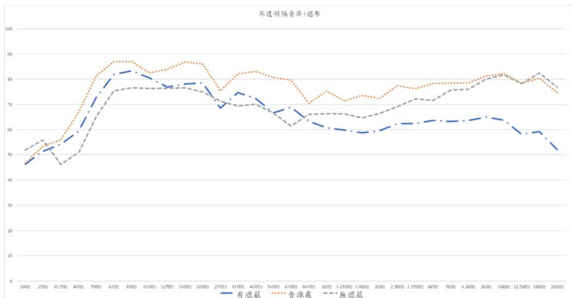
圖4.4-5 移動式防音隔屏+遮布減音量效果
