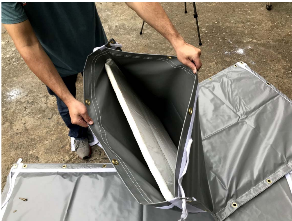
圖 3.2-14 自製防音毯，可充填吸音材料
