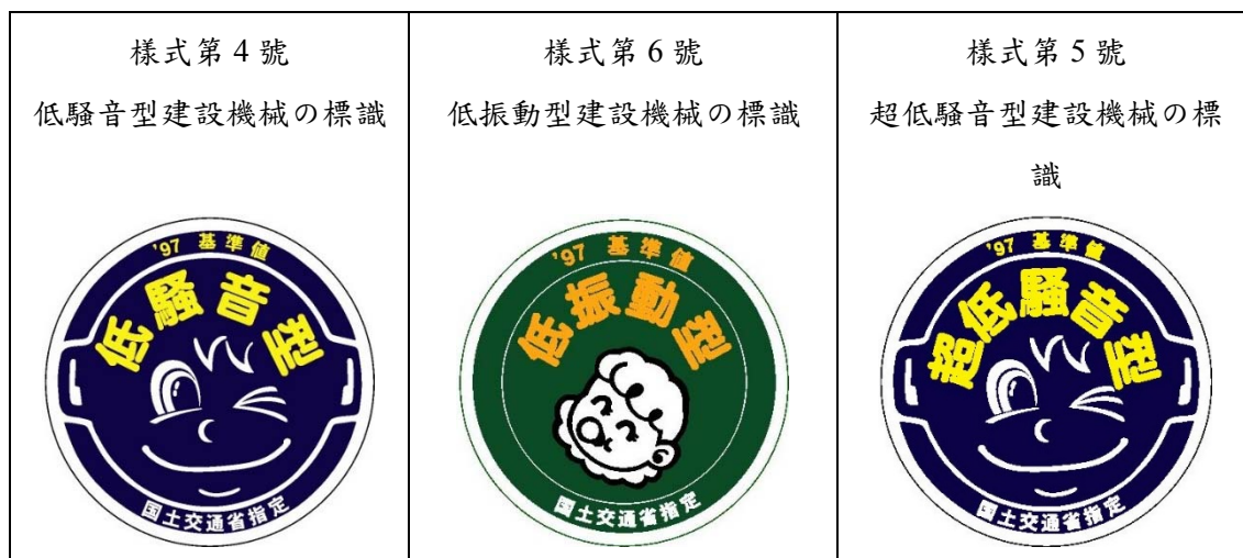
圖 3.3-1 日本建設機械低噪音、超低噪音及低振動標籤示意圖
