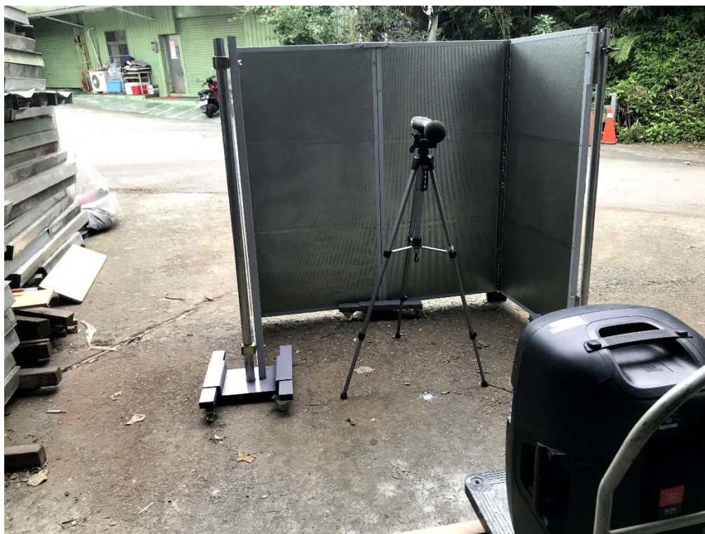
圖4.4-10 移動式防音隔屏90°正面
