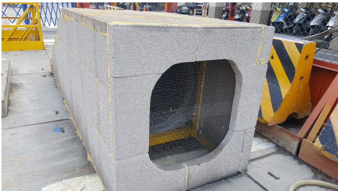
圖 3.2-4 營建業者自製隔音罩
