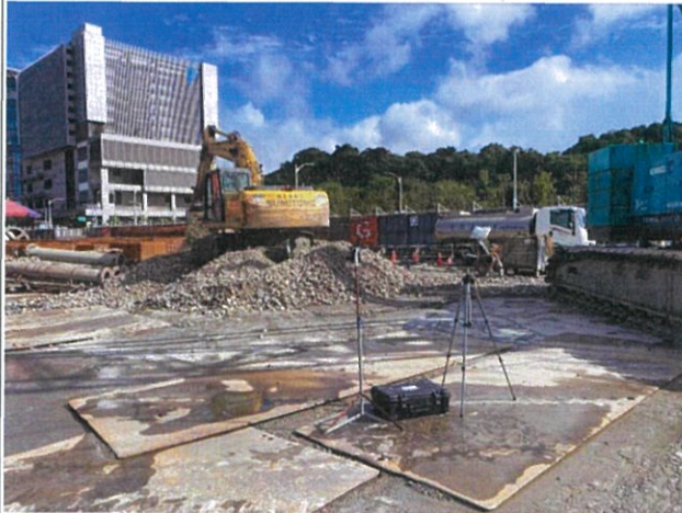
測量項目：營建工程噪音 測量地點：怪手旁 10 公尺處 測量日期：109 年 11 月 06 日
