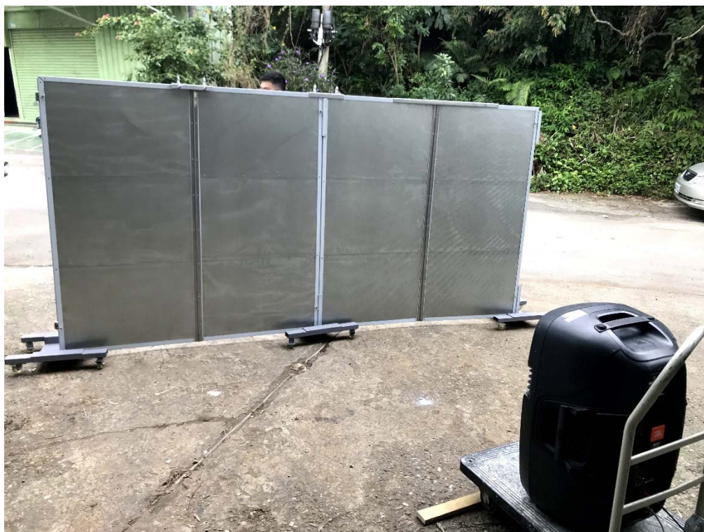
圖4.4-2 移動式防音隔屏成品正面
