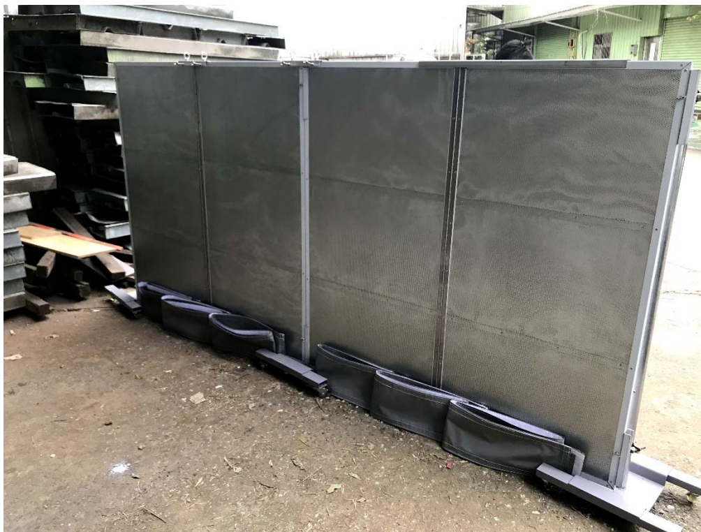
圖 3.2-10 新式移動式防音屏
