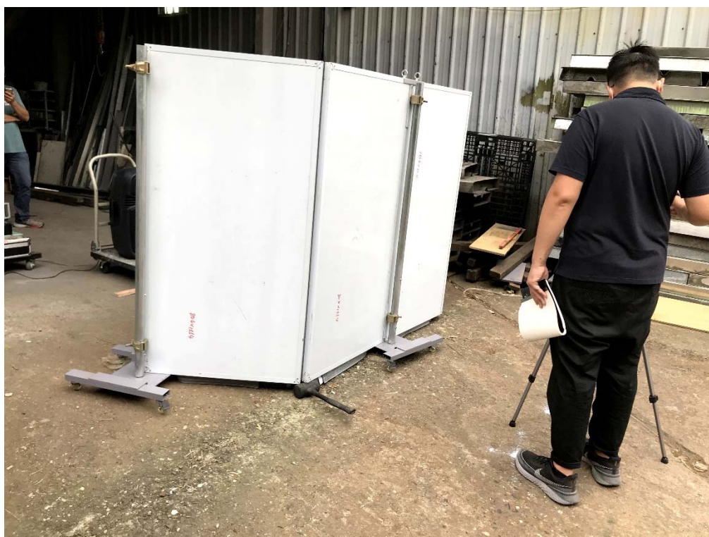
圖4.4-7 移動式防音隔屏135°背面
