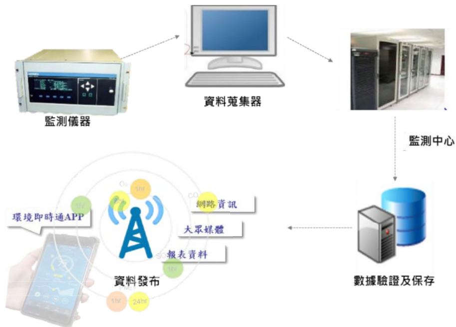
圖 2-1 空氣品質監測網資料處理流程圖
