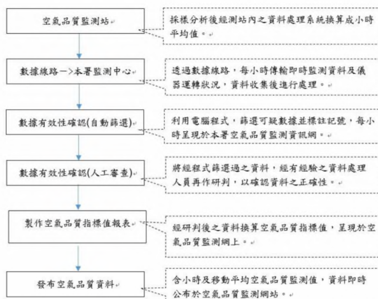
圖 2-1 空氣品質監測網資料處理流程圖
