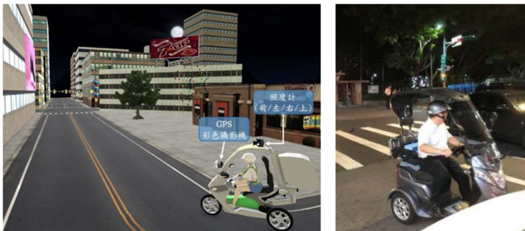
圖 3 環境光污染源動態監測方法 左圖為示意圖，右圖為監測實景圖
