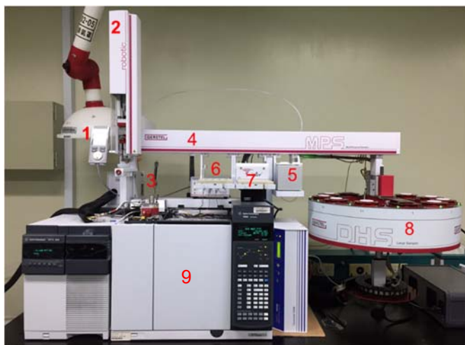
圖 1. 多功能自動進樣裝置／氣相層析質譜儀：(1)控制面板(2)注射塔(3)熱脫附元件(4)X軸軌道(5)加熱旋轉箱(6)20 mL 頂空樣品盤(7)2 mL 液體樣品/TDU tube 樣品盤(8)動態頂空(9)氣相層析質譜儀
