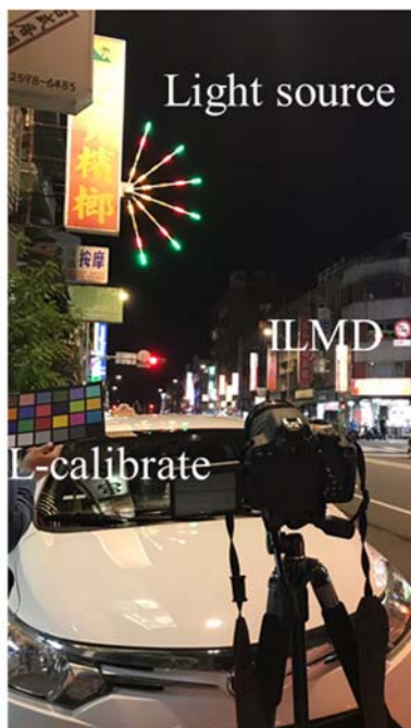
圖 2 LED 組合燈閃爍量測實景圖
