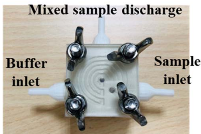
圖 5 水樣及緩衝溶液之微流道混合槽
