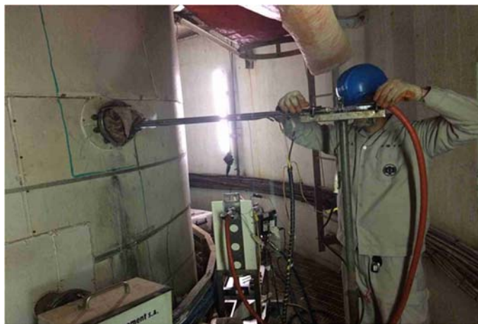
圖 1. 煙道採樣實況圖
