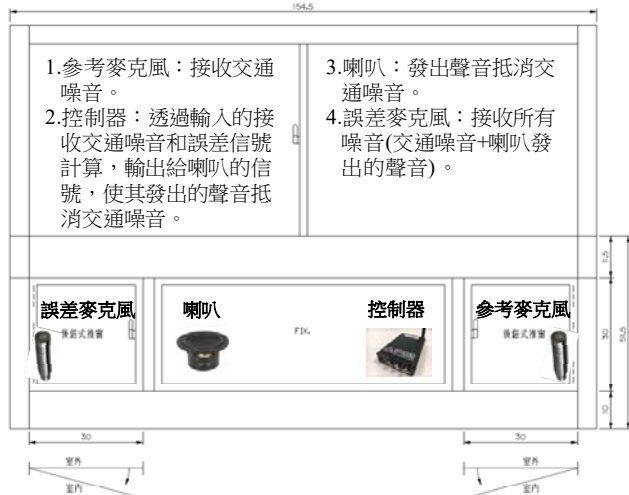
圖 6. 交通噪音主動控制各流程單元說明
