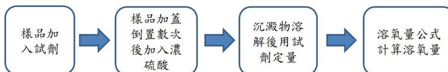
圖 3.6、溶氧量量測流程
