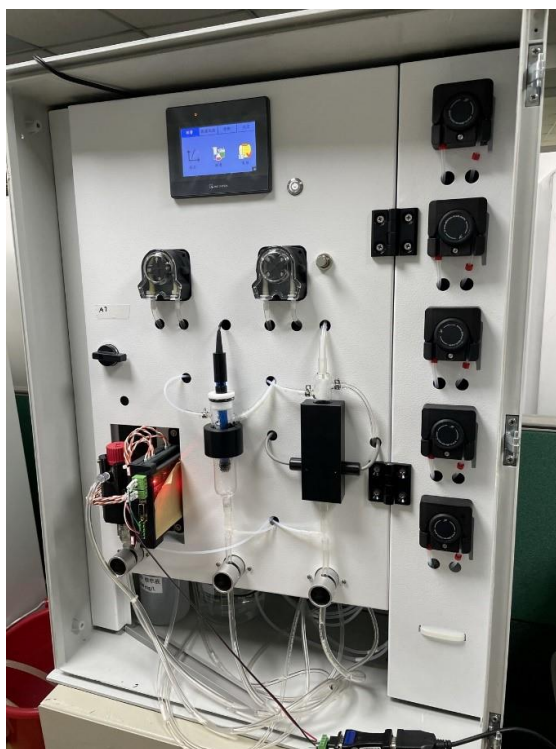
圖 9 整合 COD/SS 感測模組之固定式水質感測器照片
