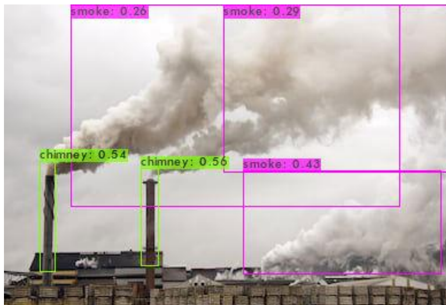
圖 4.以圈煙模型鎖定煙柱後進行影像判煙作業
