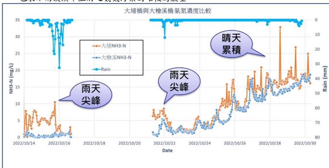
圖 13 南崁溪大埔橋及大檜溪橋 10 月氨氮濃度比較
