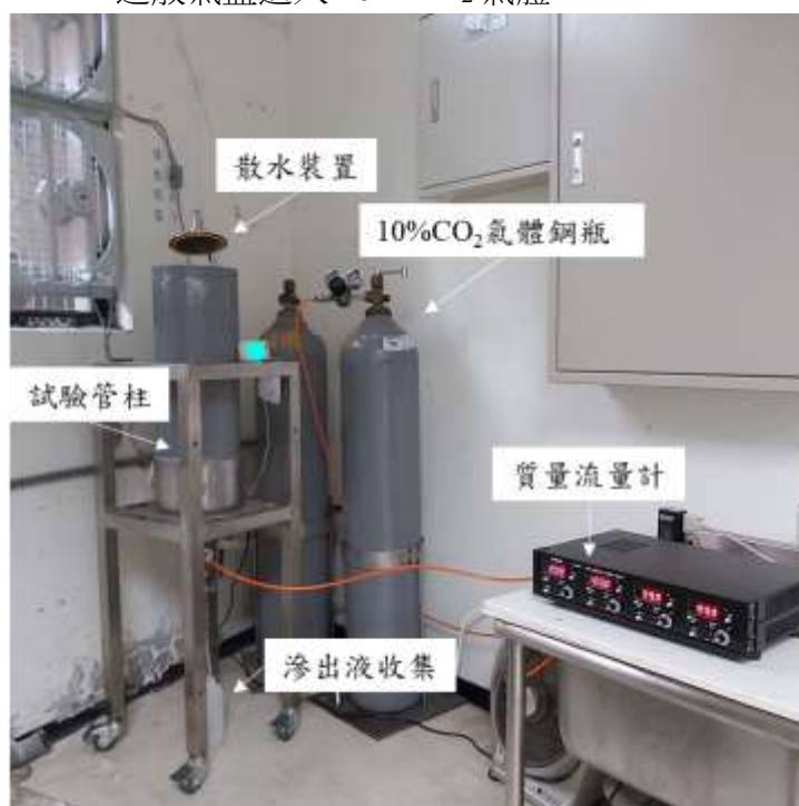
圖 3.1-5 散水通氣熟化裝置示意
