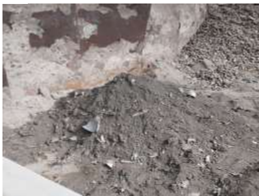
圖 2.5-6 臺中市烏日廠之採樣情形照片(a)焚化底渣；(b)焚化再生粒料
