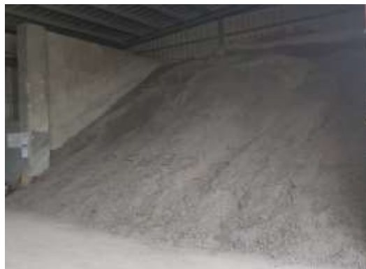
圖 2.5-6 臺中市烏日廠之採樣情形照片(a)焚化底渣；(b)焚化再生粒料
