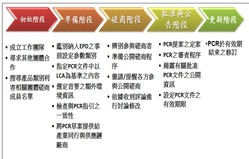
圖 3-2、ISO 14025 產品類別規則(PCR)制定流程图
