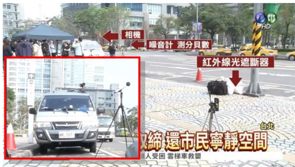
圖 5.1-1 臺北市環保局、臺中市環保局「高噪車輛照相系統」示意圖
