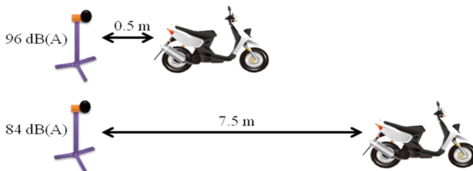
圖 5.1-2 「高噪車輛照相系統」觸發位準 84 dB(A)設定示意圖
