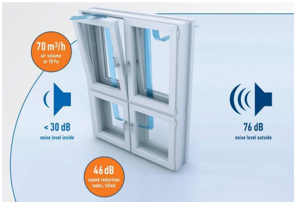
圖 4.1-1 德國公司 Eilenburger 受歐盟資助研發之傾斜式被動通風箱型隔音窗原理 [1]
