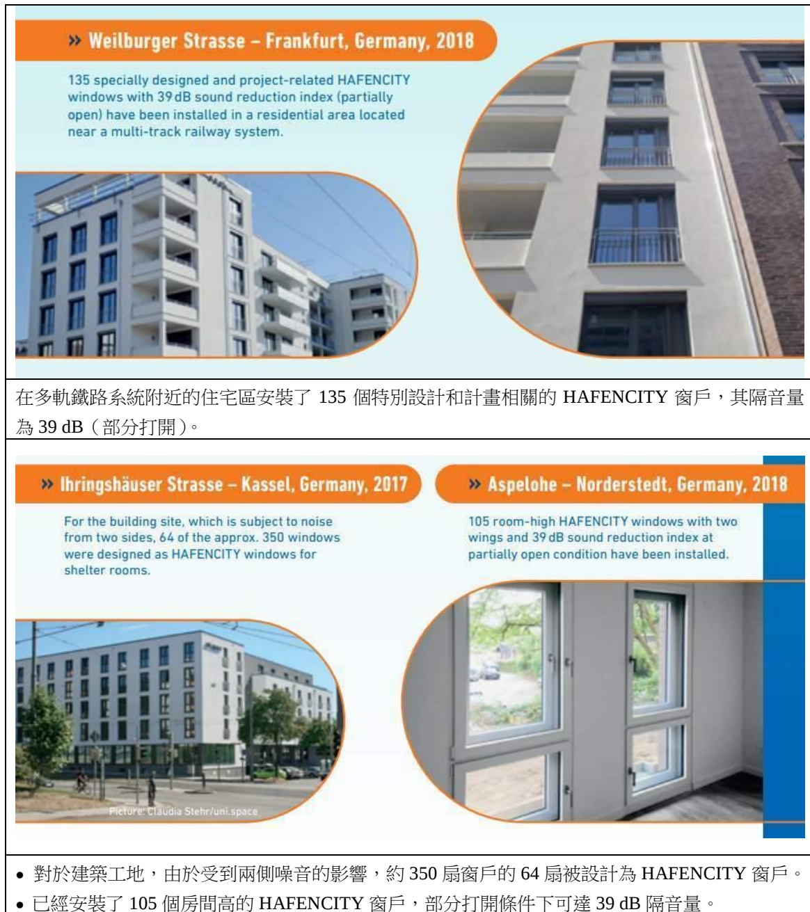
圖 4.1-4 德國公司 Eilenburger 之傾斜式被動通風箱型隔音窗應用 [4]
