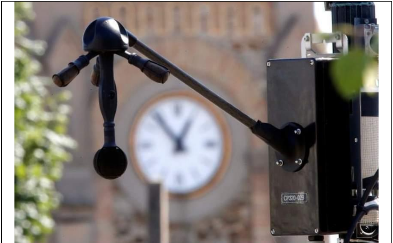
新安裝的「噪音雷達（noise radar）」，一種可以精確測量和定位移動車輛聲音及登記車牌的測量裝置，可以在法國巴黎-奧利機場附近的 Villeneuve-le-Roi 看到（August 30, 2019. REUTERS/Charles Platiau）
