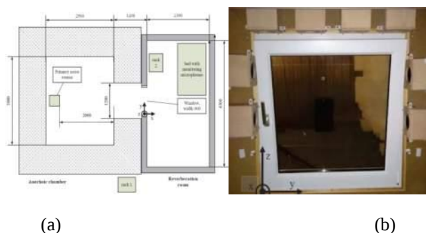
圖 4.2-7 德國：(a)聲傳播試驗室平面圖； (b)斜窗搭配適應式噪音阻隔器配置照片 [44]
