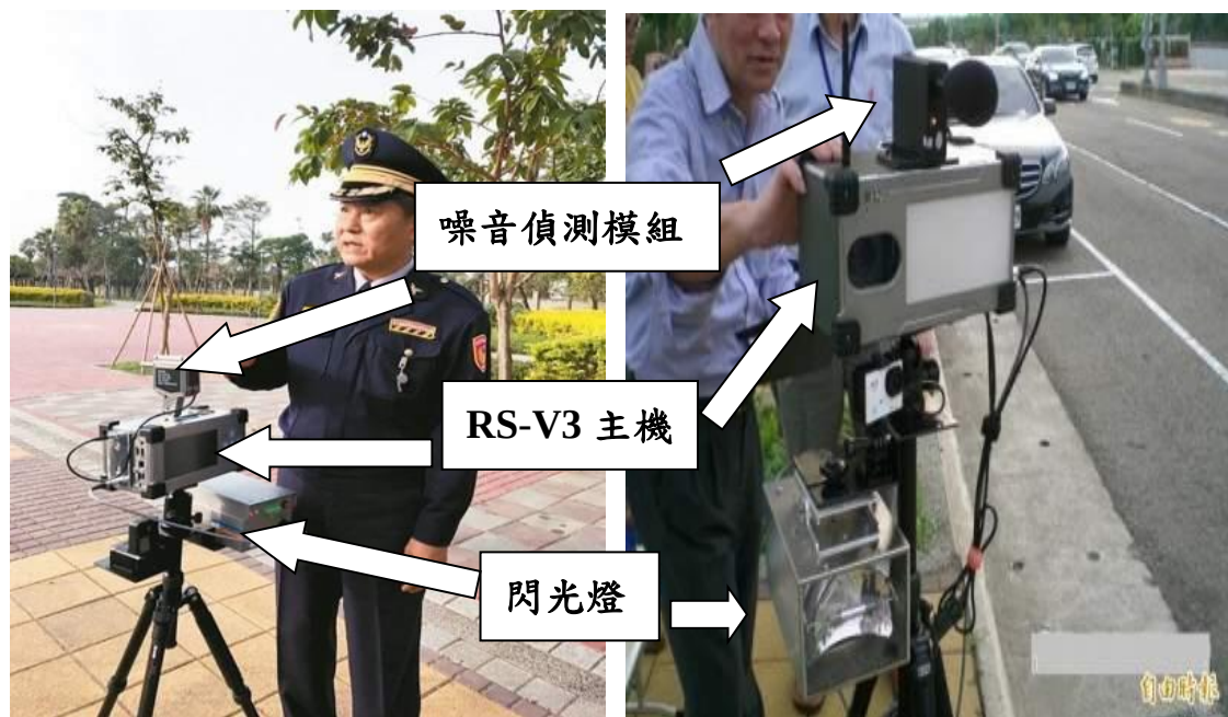
圖 5.1-4 「移動數位式雷達測速照相結合噪音偵測器設備」示意圖
