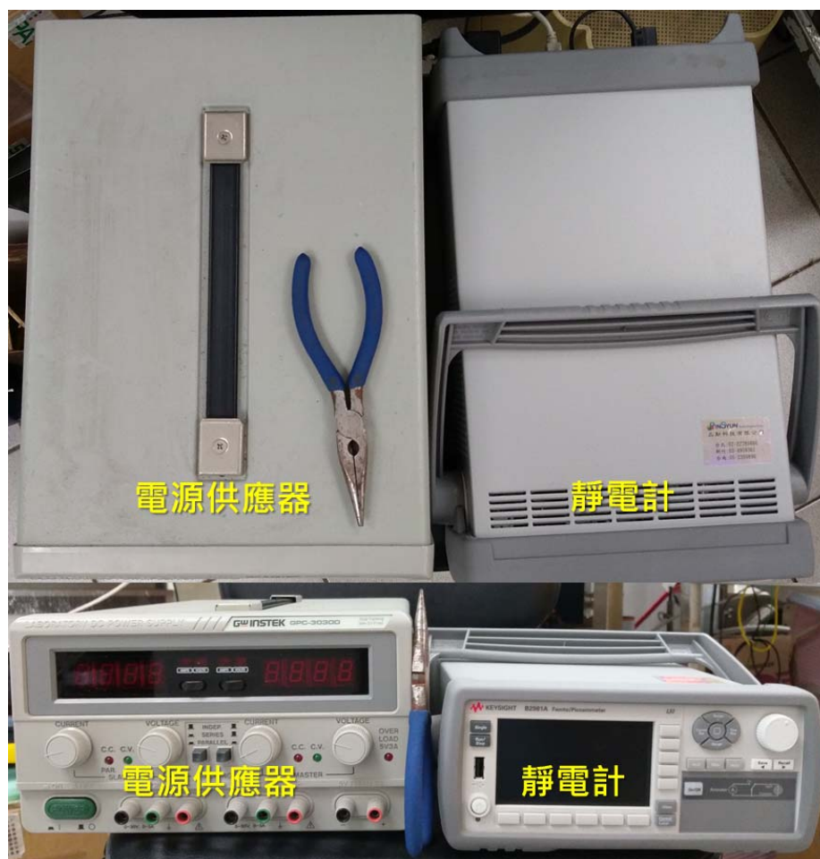
圖 3-7、測試用之電源供應器及靜電計
