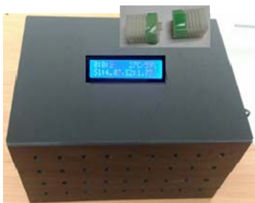
圖 3-43、共整合封裝與驅動模組裝置在場域測試雛型感測器外觀
