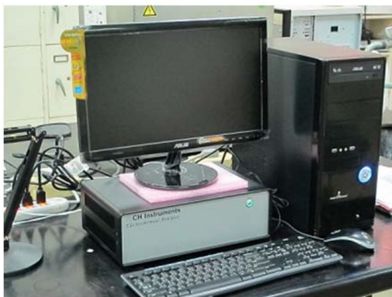
圖 3-26、電化學測試系統
