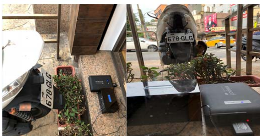
圖 3-47、雛型感測模組於自製感測器戶外機車測試
