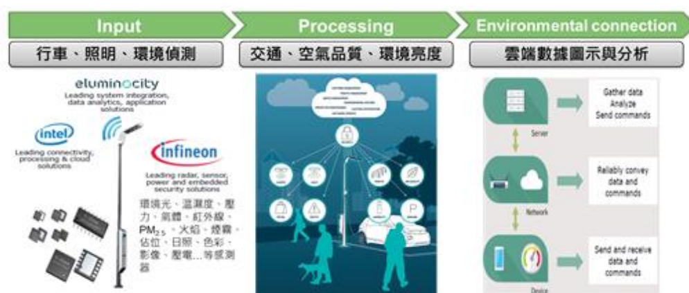
圖 6-31、Infineon 與 Eluminocity 合作開發整合電動車充電站及多種環境感測器之智慧路燈
