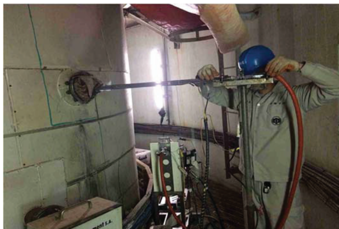
圖 1. 煙道採樣實況圖
