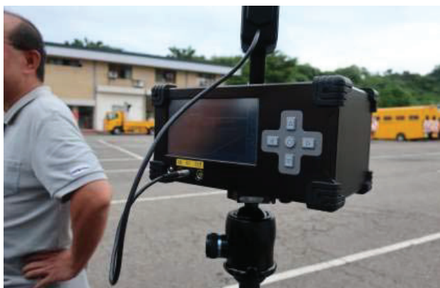
圖 1. 超音照相系統（測速+同步測噪音）示意圖
