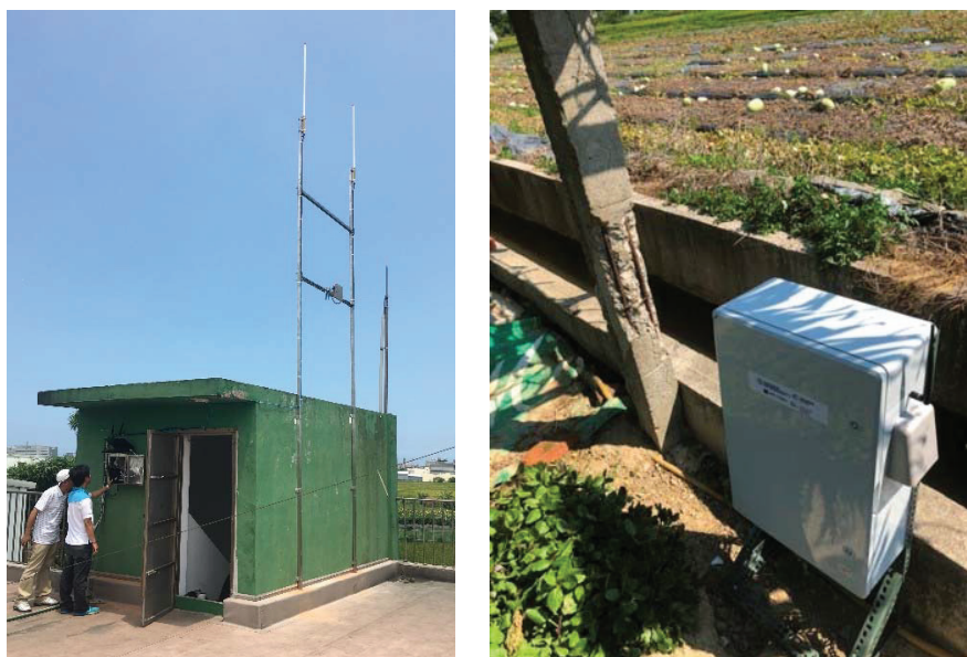
圖 9.LoRa 基地台與水質感測器實場架設圖
