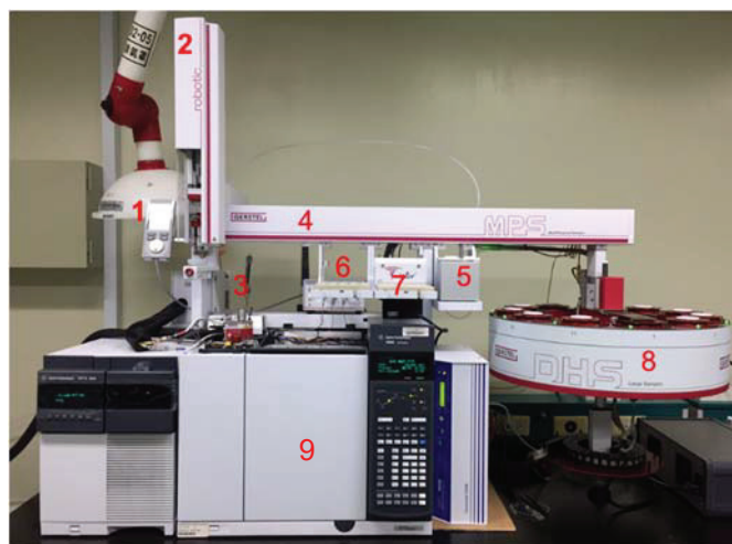
圖 3 多功能自動進樣裝置／氣相層析質譜儀：(1)控制面板(2)注射塔(3)熱脫附元件(4)X 軸軌道(5)加熱旋轉箱(6)20 mL 頂空樣品盤(7)2 mL 液體樣品/TDU tube 樣品盤(8)動態頂空(9)氣相層析質譜儀
