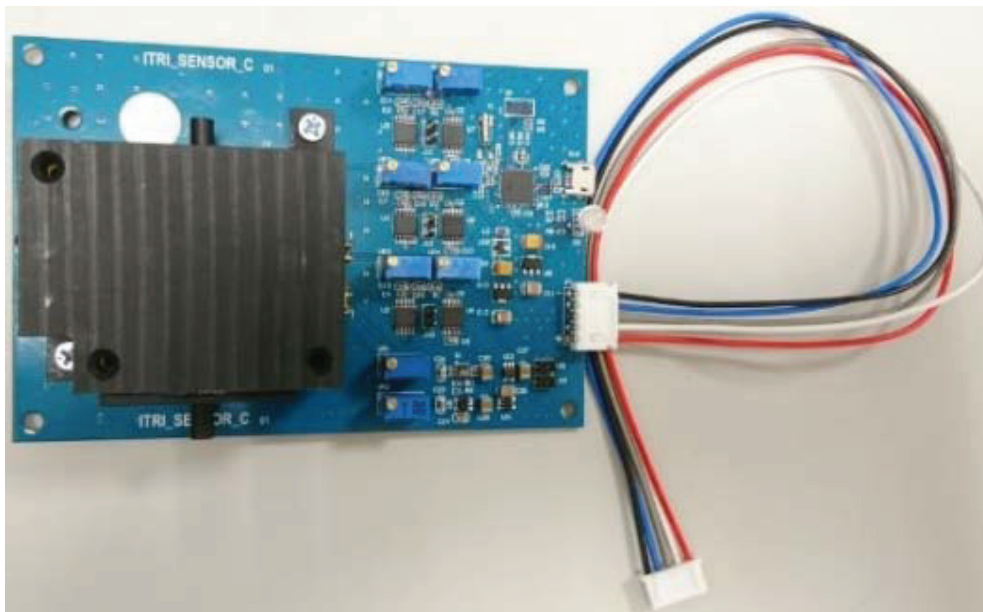
圖 6、微型化廣範圍多波長 COD/SS 檢測模組實體圖
