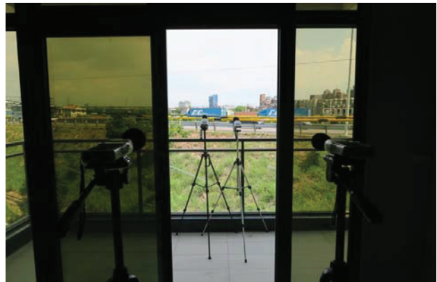
圖 1. 住宅區室內/室外噪音及頻譜資料測量狀況示意圖 註：⊗表「室內/室外同步測量」之受音點
