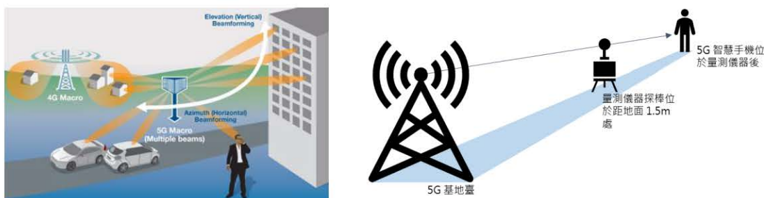
圖 2.3.2-1 5G 基地臺波束控制及測量示意圖
