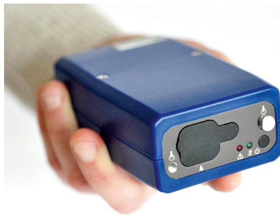
圖 4.1.6 Black carbon monitor MicroAeth AE51 外觀 (Aethlabs, 2016)
