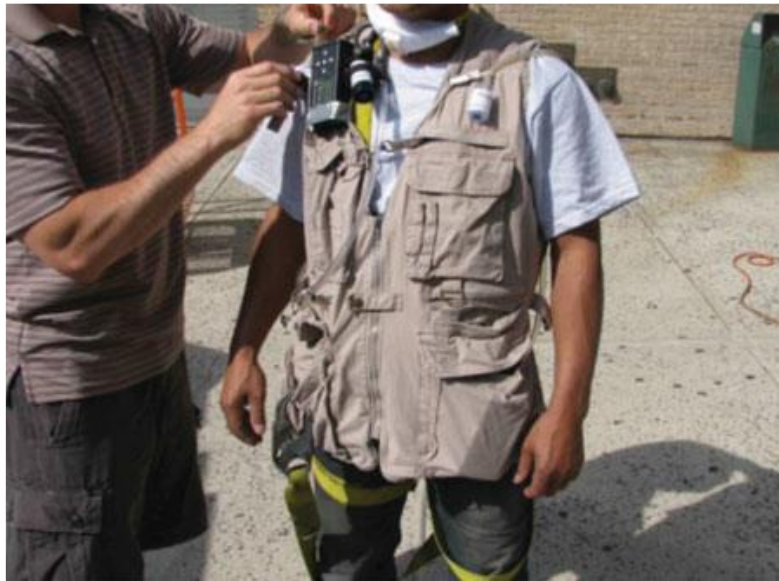
圖 4.3.1 作業人員配戴具有採樣泵及濾紙夾的採樣背心情形 (Eastlake et al., 2016)
