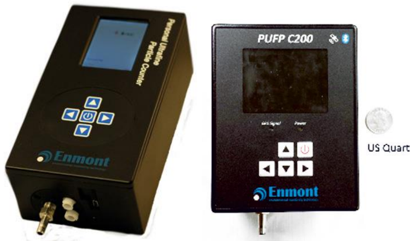
圖 4.1.5 PUFP 外觀，左 C100 型，右 C200 型 (Ryan et al., 2015)
