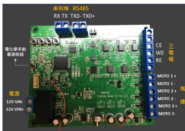
圖 1 電化學分析技術平台之電路板
