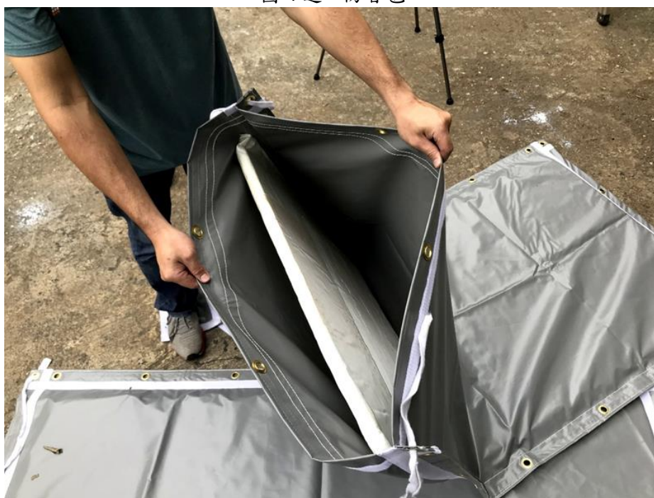
圖 5 自製防音毯及充填吸音材料
