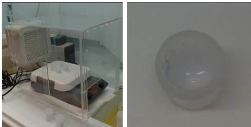
圖 3.4.5 無塵箱內微粒樣品溶液加熱蒸乾
