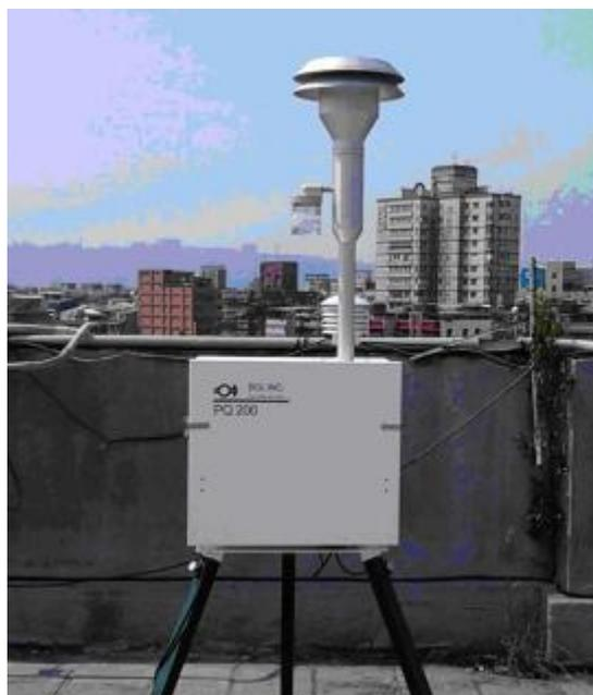
圖 3.1.4 BGI PQ200 氣膠採樣器
