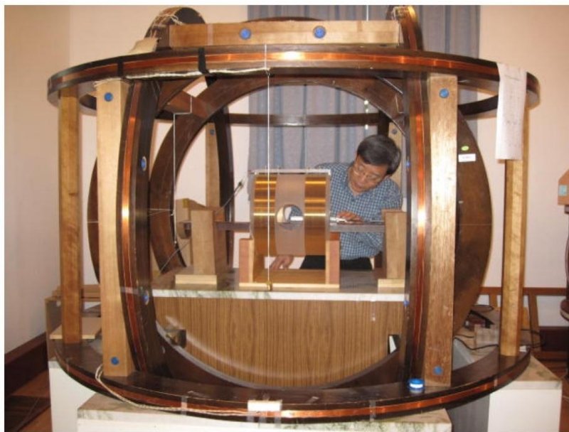
圖 2.1-13 以核磁共振磁力儀量測石英黑目合茲線圈的直流線圈常數
