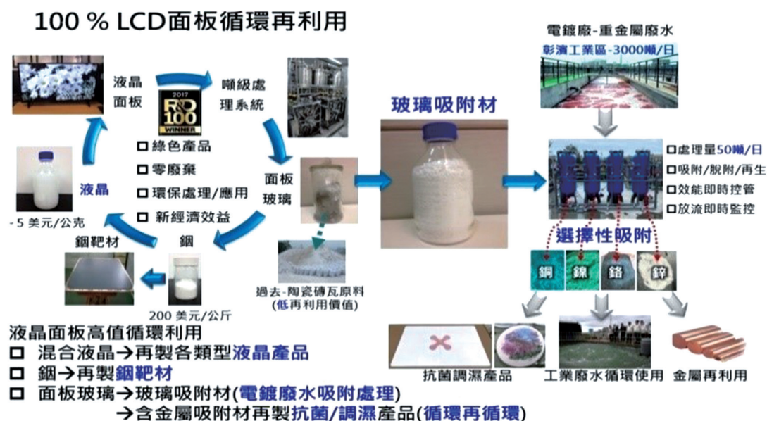
圖2-22 廢液晶面板循環再利用
