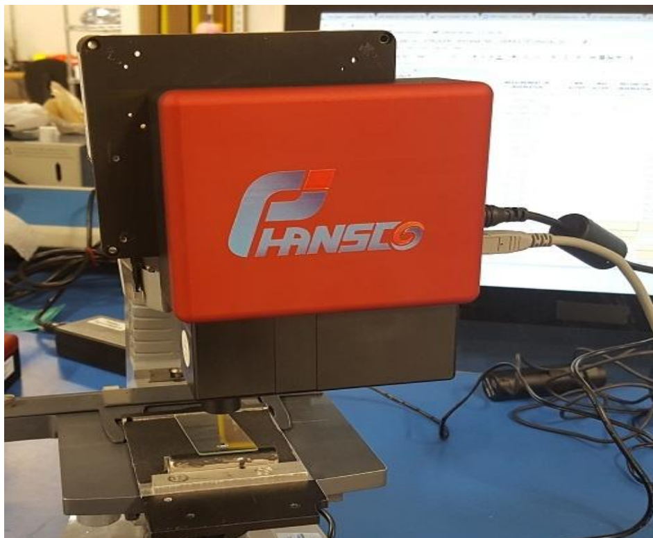
圖八 拉曼光譜靈敏度量測架構圖
