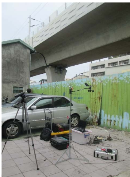
圖 4.3.2-28 測量現況(臺鐵-臺中人和路)
