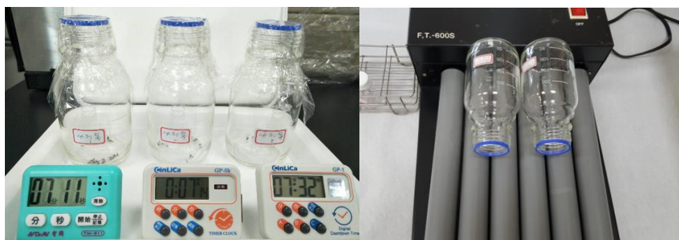
圖 4. C.D.C 藥膜玻瓶法
