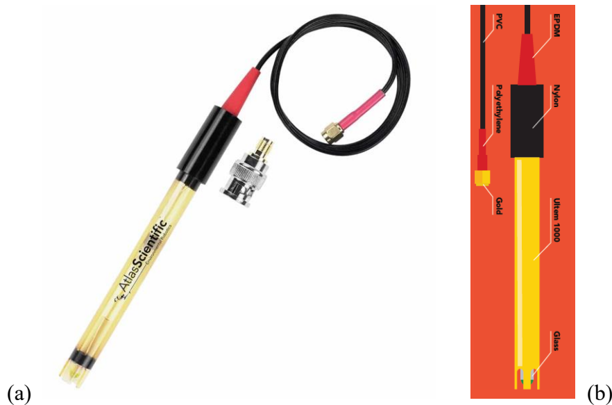
圖 2-2 美國 AtlasScientific 公司生產之 pH 電極(a)電極外觀;(b)電極材質
