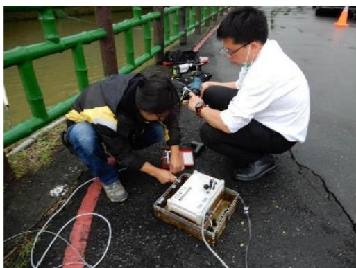
移動式水質感測器，搭配電信通訊、水質分析及AI等技術，可長時間監測pH值、導電度、溫度及溶氧等水質數值。（環保局提供）
