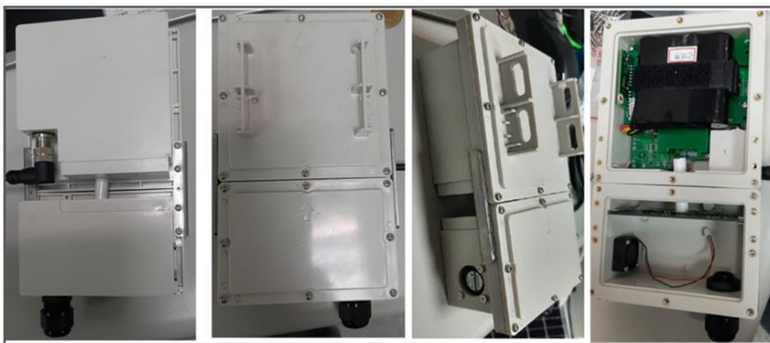
圖 3-46 主機與電池模組配置圖
