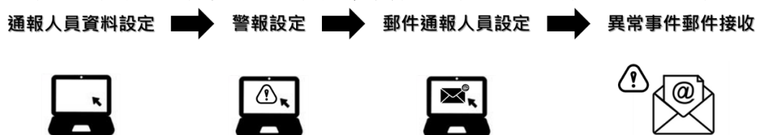
圖 5-17 異常事件自動化通報流程
