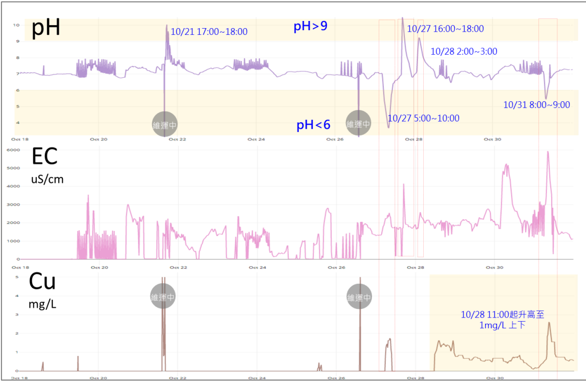
( 本圖以 10 月 19 日-10 月 31 日超標時段為例 ) 圖 4-28 塔寮坑溪 S_1 水質異常特徵
