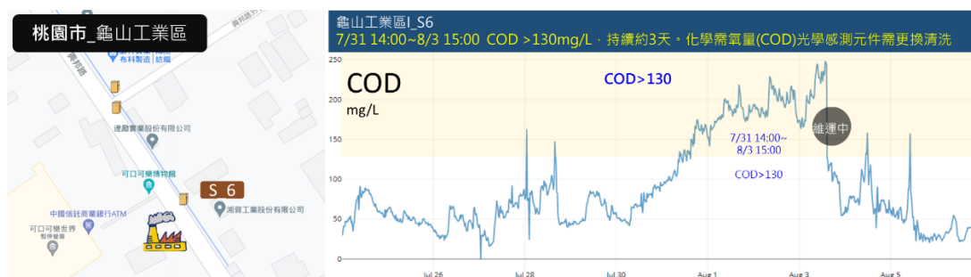
圖 4-68 化學需氧量(COD)光學感測元件污染需更換清洗
