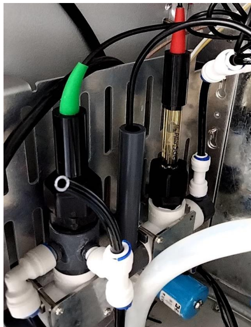
圖 2-10 pH、電導度、溫度電極及流道組裝圖
