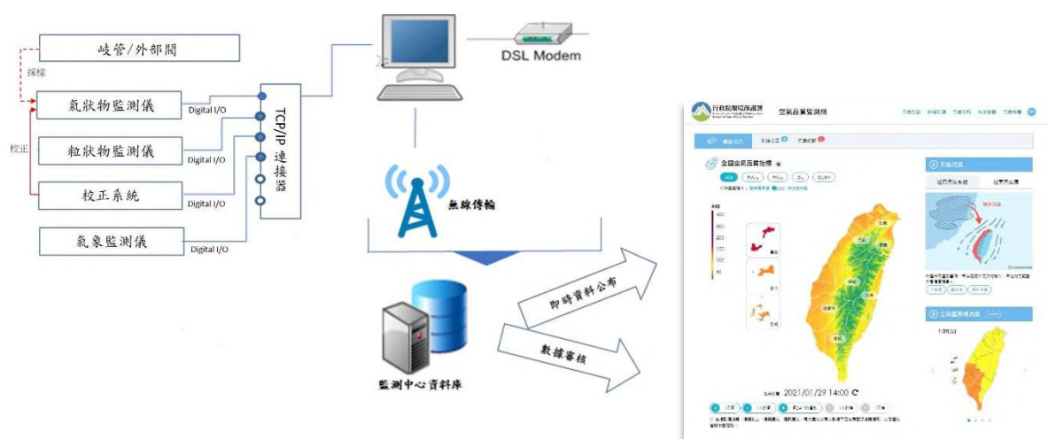
圖 2-1 空氣品質監測網資料傳輸流程圖
